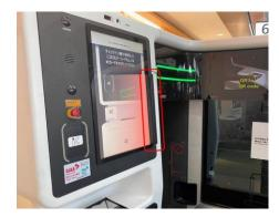
空港内の自動チェックイン機、自動手荷物預け機にタッチレスセンサ(\*2)を取り付けることで、操作画面に直接触れることなく、ご搭乗手続きや手荷物タグの発行(\*3)をしていただけます。タッチレスセンサから出る赤外線(\*4)により、お客さまは画面に触れることなく機器を操作することができます(\*5)。(羽田・新千歳・伊丹・福岡・沖縄空港に導入済み)
